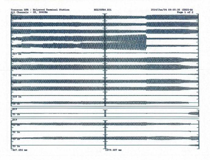
Figure 2: Holyrood Generator #1 Trip at 9:05:37 Jan. 4, 2014
